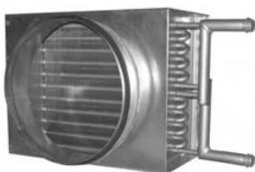
Стандартно нагреватели выпускаются двухрядные и трехрядные, благодаря чему можно более точно подобрать калорифер с необходимой мощностью. Корпус канального нагревателя выполнен из оцинкованной стали. Теплообменная поверхность образована рядами медных трубок, гофрированными пластинами из алюминиевой фольги. Применяемые материалы обеспечивают высокую эффективность, надежность и долговечность работы канальных нагревателей.
