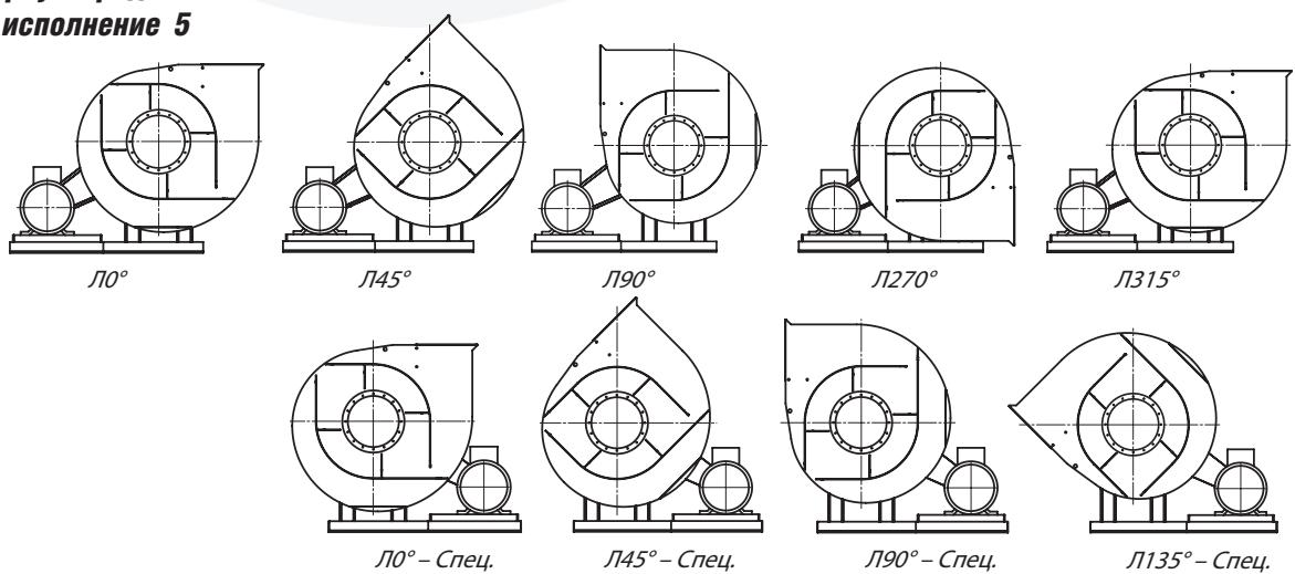
**Рекомендации по монтажу и установке радиальных вентиляторов в вентиляционных системах для наиболее распространенных вариантов компоновки. Нарушение данных рекомендаций может повлечь значительное снижение кривой давления.**
