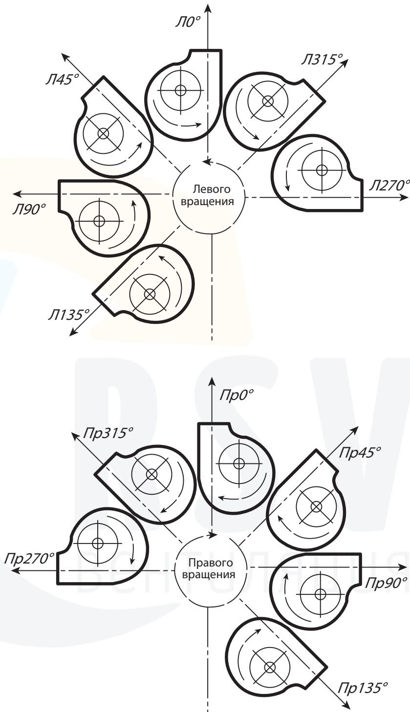
**Положение корпуса радиального вентилятора, исполнение 1, 3**
