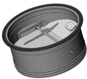
Конструкция стаканов монтажных для вентиляторов, устанавливаемых на кровле (стаканы типа СТМ и СТМ-ОСВ) предусматривает установку клапана. Открытие клапана происходит под действием потока воздуха, возникающим при включении вентилятора. При выключении вентилятора поток воздуха прекращается и заслонка(и) под воздействием силы тяжести на противовес возвращается в исходное положение.
