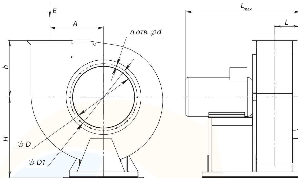
Схема расположения отверстий для крепления вентилятора
