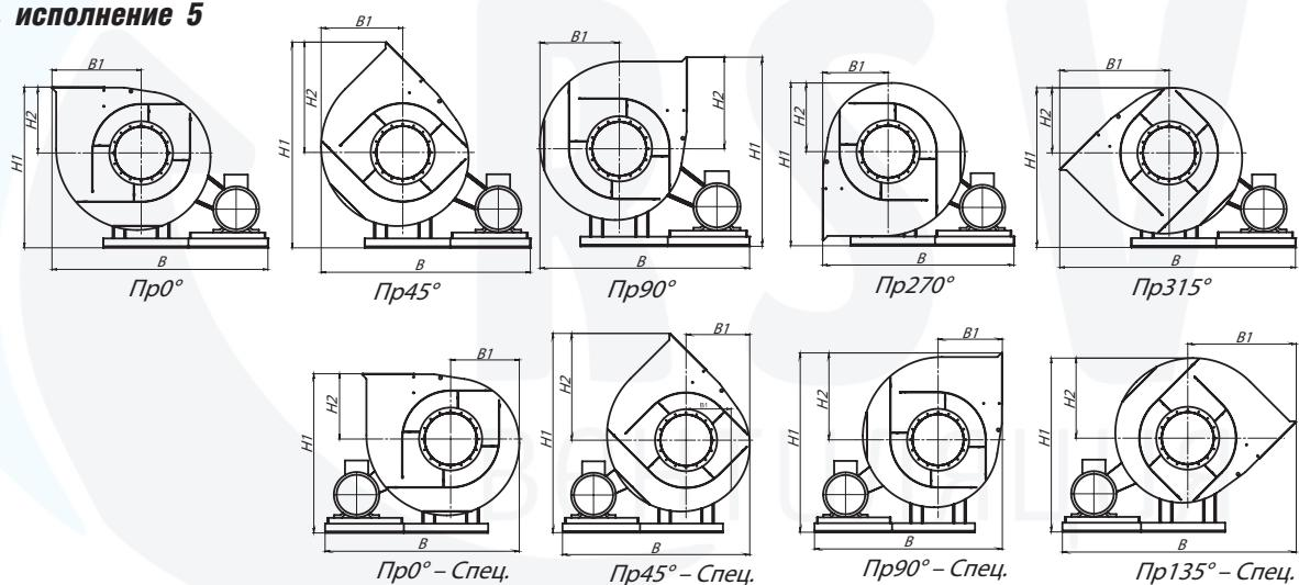
**Положение корпуса радиального вентилятора, исполнение 5 (левое)**
