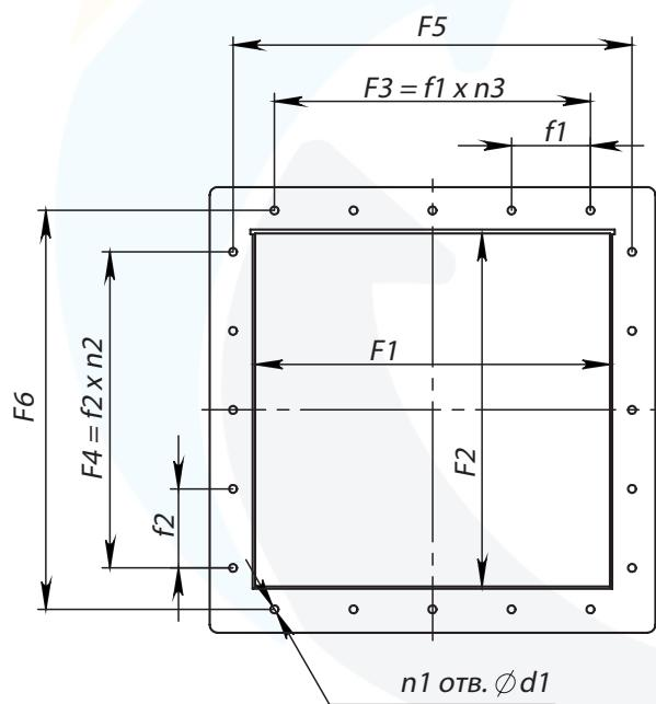
Схема расположения отверстий для крепления вентилятора
