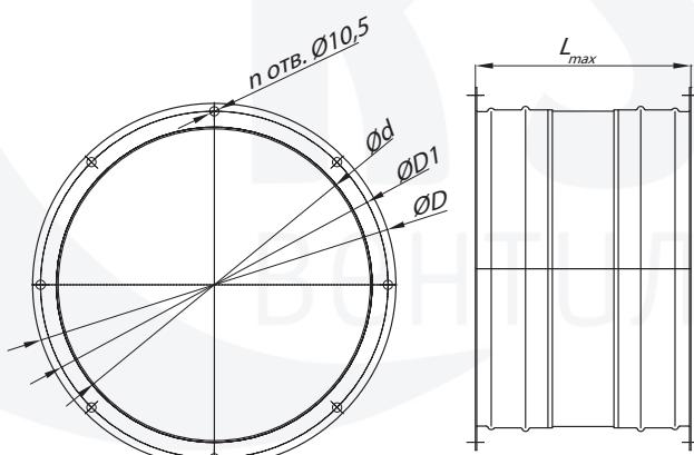
Гибкая вставка «В» типа «фланец-фланец»
