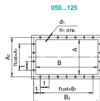
Расположение отверстий крепления вентиляторов
