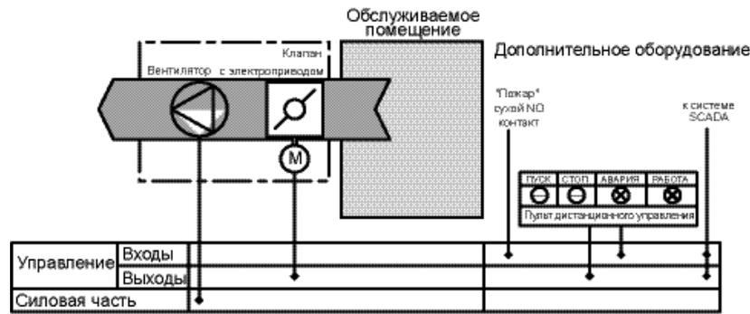
ШСАУ-ВДУ / ШСАУ-ВПД прямой пуск двигателя вентилятора
