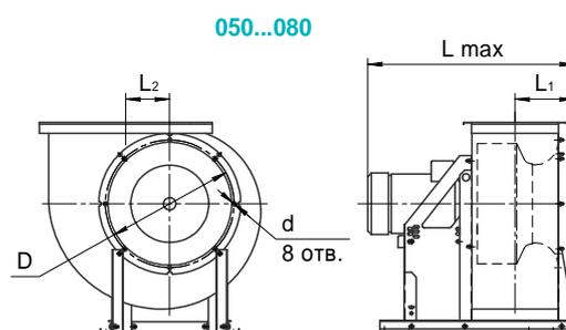
Выходной фланец вентиляторов
