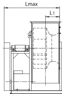
Расположение отверстий крепления вентиляторов
