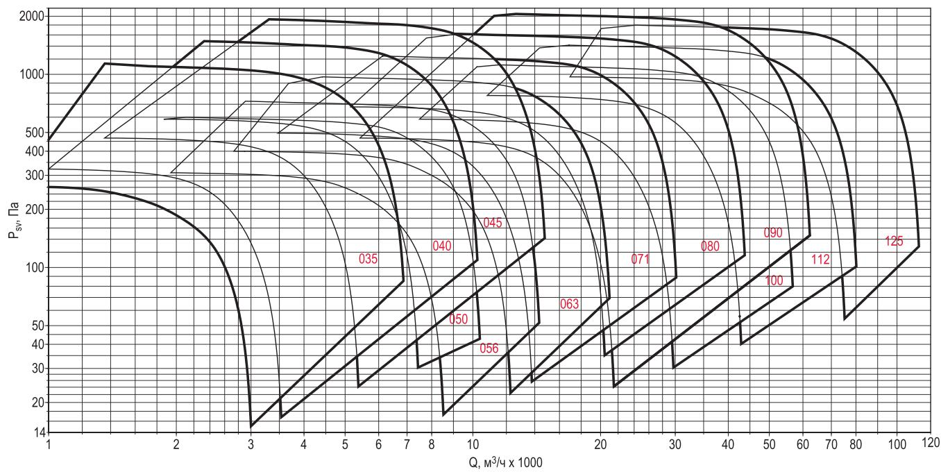
**КРОВ-ДУВ-Ф вентилятор с использованием ЧРП**
