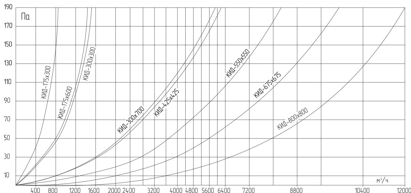
Пропускные характеристики клапанов КИД указаны для обычных параметров воздушной среды: плотность 1,2 кг/м<sup>3</sup> при температуре 20°C.
