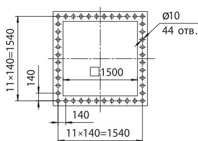
Выходной фланец вентиляторов
