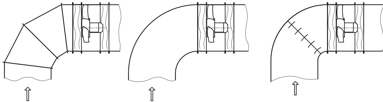
При необходимости установки поворотных участков сети непосредственно вблизи вентилятора рекомендуется использовать составное колено или поворотный участок с большим радиусом закругления, или поворотный участок с расположенной в нем системой лопаток.
