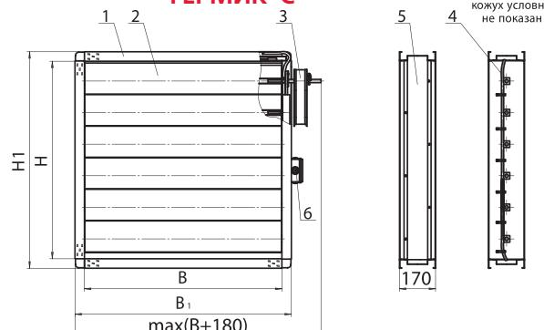
1 – корпус; 2 – лопатка; 3 - исполнительный механизм; 4 - саморегулирующийся нагревательный кабель; 5 – утеплитель; 6 – клеммник
