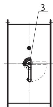
1 – корпус; 2 – лопатка; 3 – исполнительный механизм.
