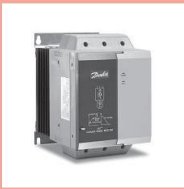
Устройства плавного пуска - софт-стартеры – это электронные приборы, регулирующие напряжение, подаваемое на двигатель, обеспечивая при этом плавное увеличение/уменьшение скорости двигателя в моменты пуска и торможения. Применяются устройства плавного пуска VLT® MCD фирмы «Danfoss».
