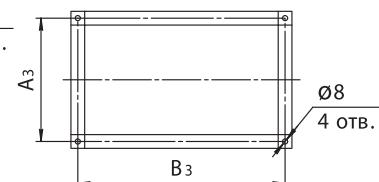
Расположение отверстий крепления вентиляторов
