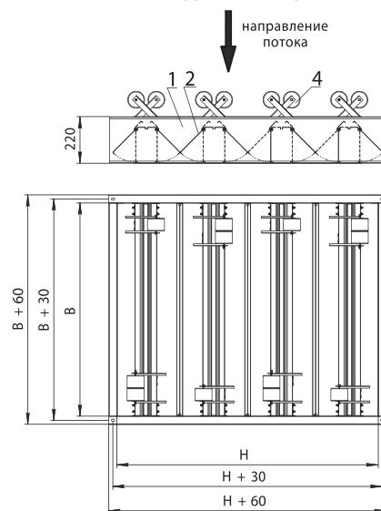
1 – корпус 2 – лопатка 3 – переходник 4 – противовес.
