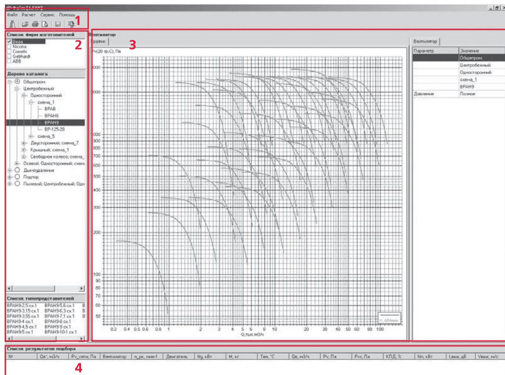
**1. Главное меню и панель инструментов** обеспечивают доступ к основным функциональным возможностям программы: начать новый расчет, изменить данные и повторить существующий расчет, удалить расчет из списка, сохранить список расчетов в файл, восстановить список расчетов из файла, создать отчет с возможностью предварительного просмотра, вывода на печать и экспорта в Word, изменить настройки программы.
