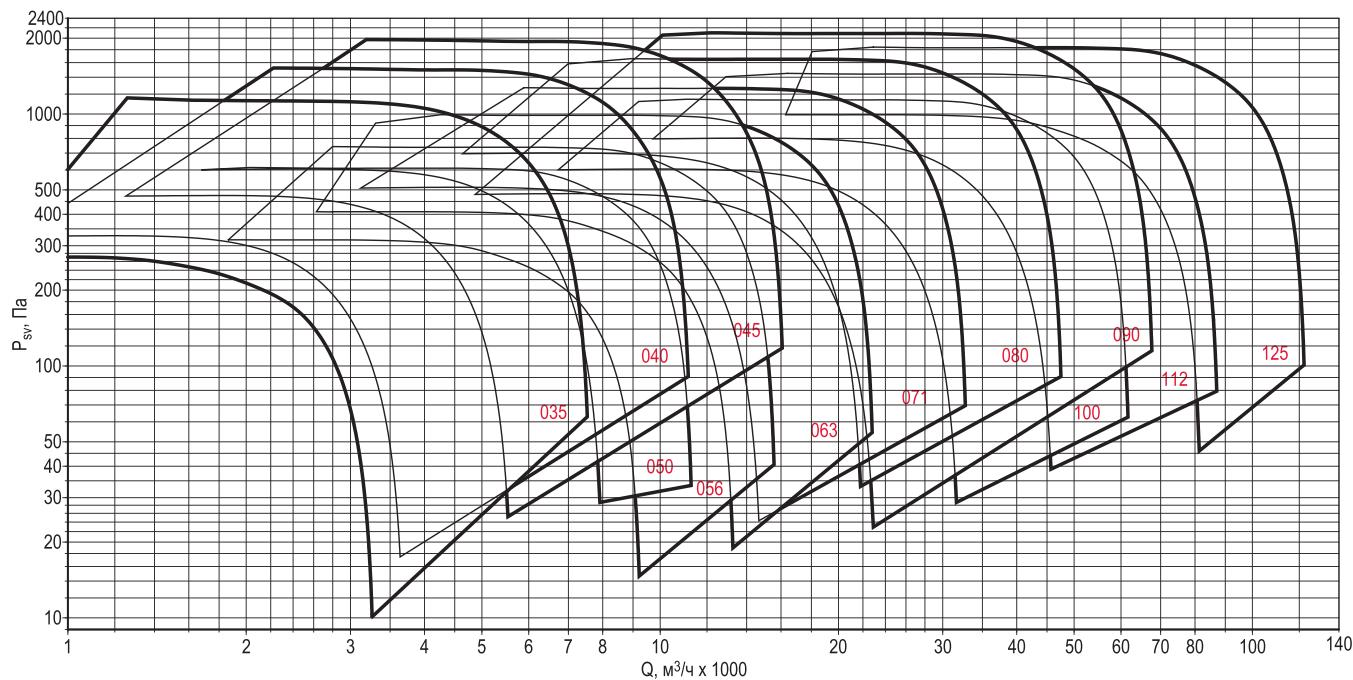
**КРОС-ДУВ-Ф вентилятор с использованием ЧРП**
